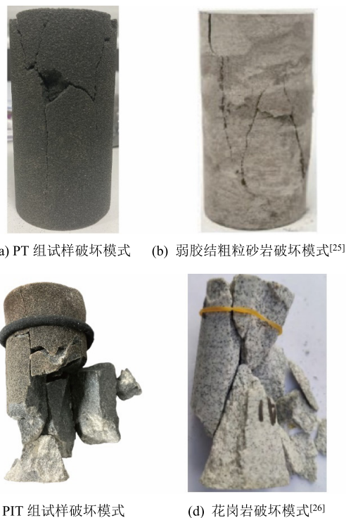
图 12 不同后处理 3D 打印类岩石试样与天然岩石破坏模式对比
